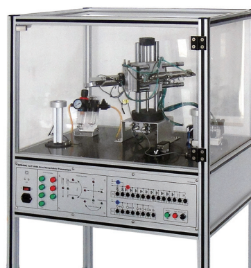
DLFA-5DPR-B 五自由度气动机械手实训系统 Five Axes Manipulator Training System
