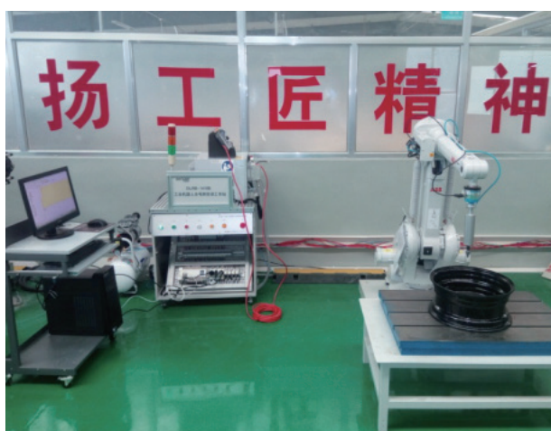
DLRB-1410B 工业机器人去毛刺实训工作站 Industrial Robot Deburring Training Workstation
