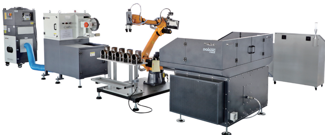
DLRB-PER16 工业机器人打磨抛光工作站 Industrial Robot Grinding & Polishing Workstation
